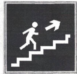
Направление к эвакуационному выходу по лестнице вверх
